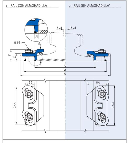
Ancho mínimo de montaje - W = Ancho de Rail (F) + 100mm V = Ancho de rail (F) + 16mm Ancho de rail (F) + 129mm
